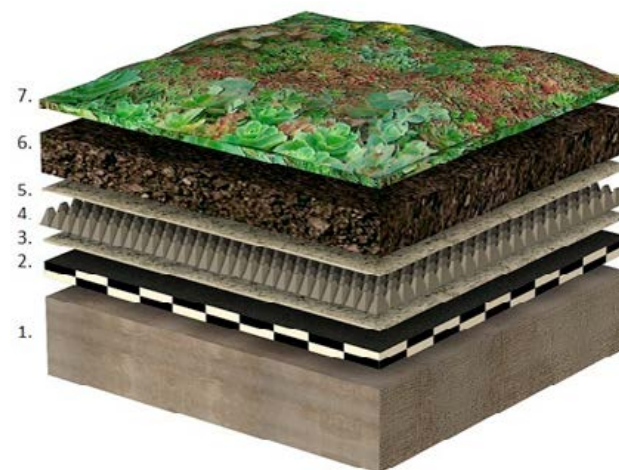
Figuur 9: Basisopbouw daktuin met wortelwerende dakbedekking.
